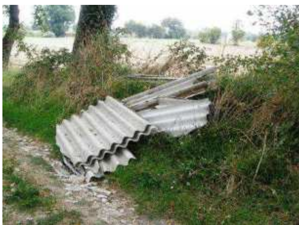
Immagine di una tipica lastra di amianto
